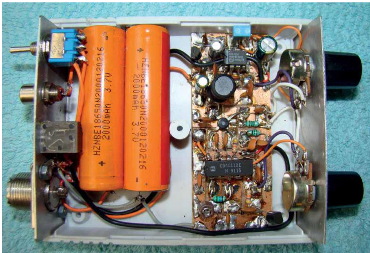
Fot. 7.4.5. Wykonanie odbiornika na elementach przewlekanych
