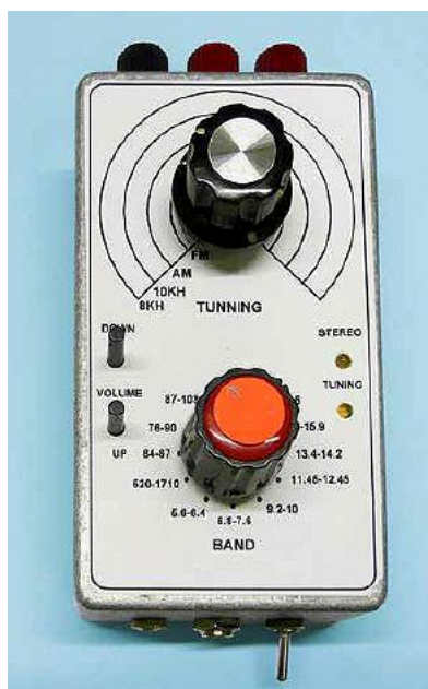
Rys. 8.1.2. Przykład konstrukcji mechanicznej 12-zakresowego odbiornika PE1KTH ( Funkamateur 11/2016)
